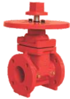
VÁLVULA DE COMPUERTA CON BRIDA Y PLACA REDONDA MOD.Z45 200PSI 4"
